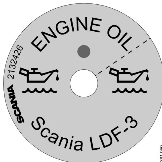
Étiquette de remplissage dans le bloc-moteur.
