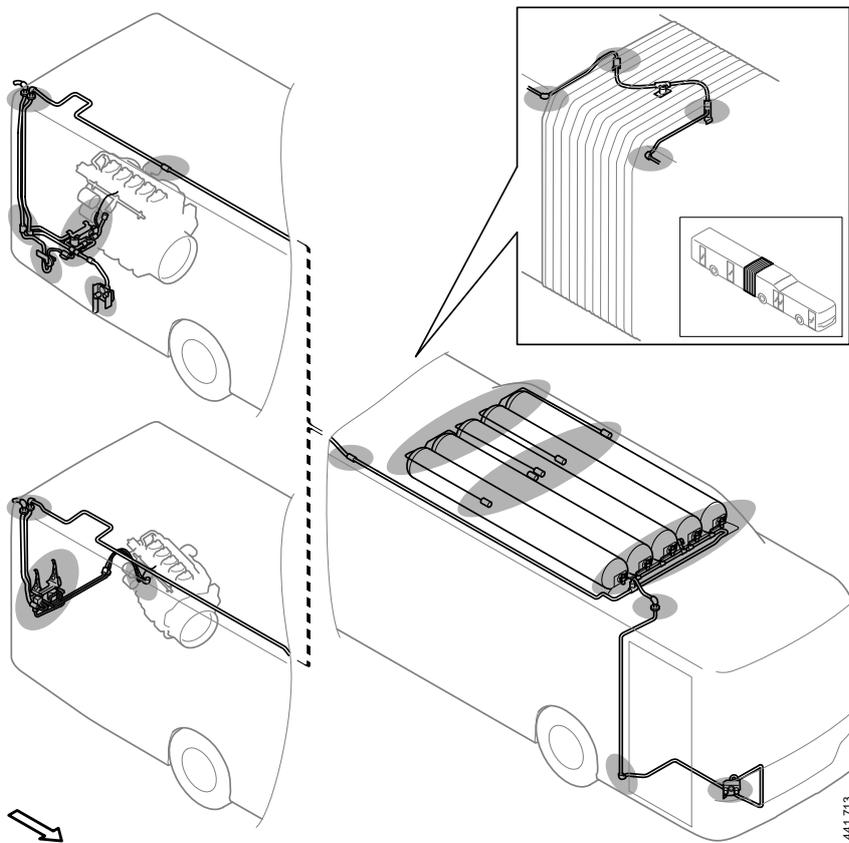
瓦斯管線配接和灌注頭位置的範例，依車體型號而有所不同。
