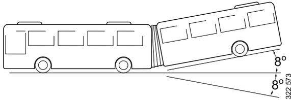
在關節聯結機構上，底盤允許的傾斜角度為  $8^\circ$ 。視巴士車體打造而定，此角度可能會較小。因此，在舉升時必須留意，以免超過此角度限制。
