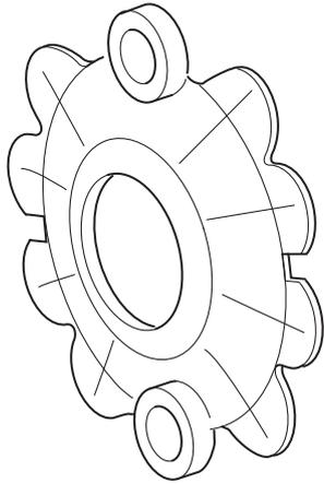
安裝護蓋與 Scania 零件編號 1 850 975 以防止灰塵進入。將螺帽鎖緊至 100 Nm。
