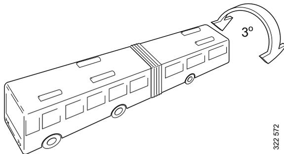
在關節聯結機構上，底盤允許的旋轉角度為  $3^\circ$ 。視巴士車體打造而定，此角度可能會較小。
