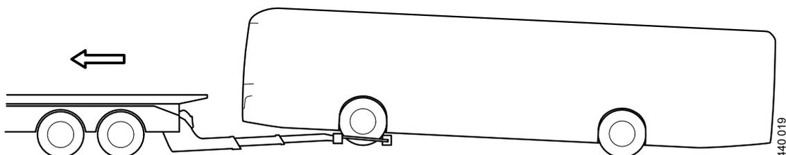
舉升車輪可將救援及拖吊期間底盤和車體受損的風險降至最低
