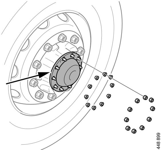
Muttern und Kegel ausbauen. Auf die Kante des Flanschs klopfen, wenn die Kegel festkleben.
