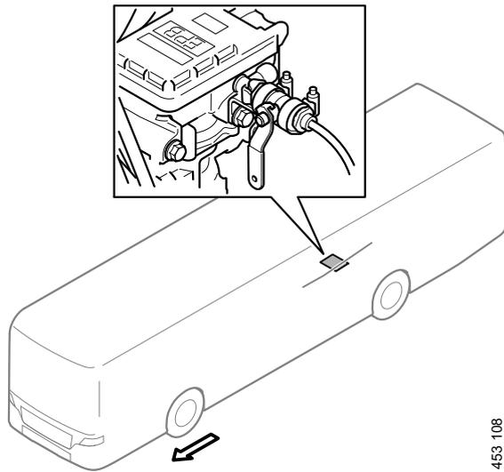
Der Zugang zum Kugelventil erfolgt über die Zugangsklappe für Bremskomponenten im Gang vor der Hinterachse.
