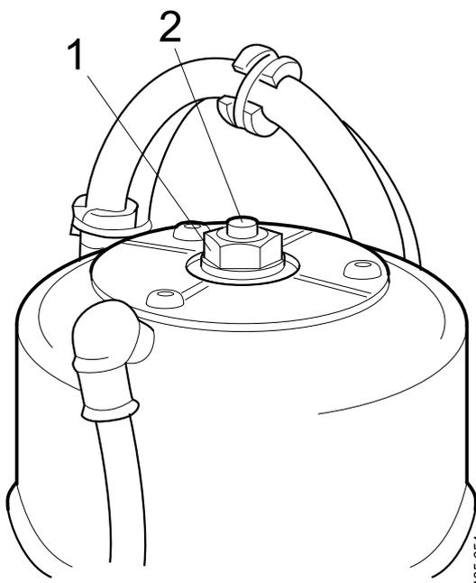
Entlastungsschraube herausdrehen, bis die Feststellbremse am betreffenden Rad vollständig gelöst ist.
