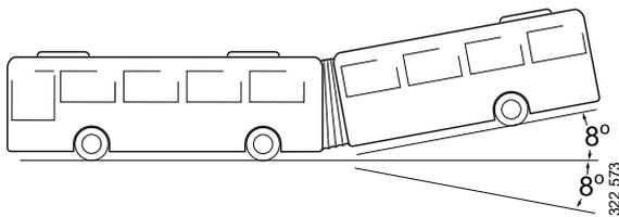
Das Fahrgestell lässt in der Gelenkeinheit einen Neigungswinkel von 8° zu. Je nach Busaufbau kann dieser Winkel kleiner ausfallen. Beim Anheben vorsichtig vorgehen, um diesen Winkel nicht zu überschreiten.
