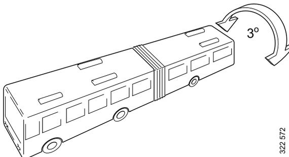
Die Bauweise des Rahmens lässt in der Gelenkeinheit einen Drehwinkel von 3° zu. Je nach Busaufbau kann dieser Winkel kleiner ausfallen.
