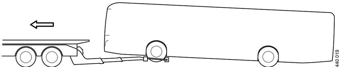
*Durch das Anheben der Räder wird das Risiko von Schäden an Fahrgestell und Karosserie beim Bergen und Abschleppen minimiert.*
