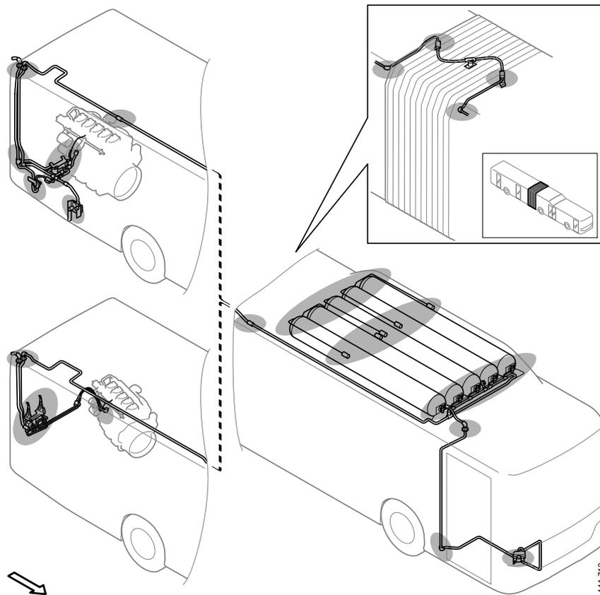
*Beispiele für die Verlegung der Gasleitung und die Anordnung der Füllnippel; je nach Karosseriemodell können Varianten auftreten.*
