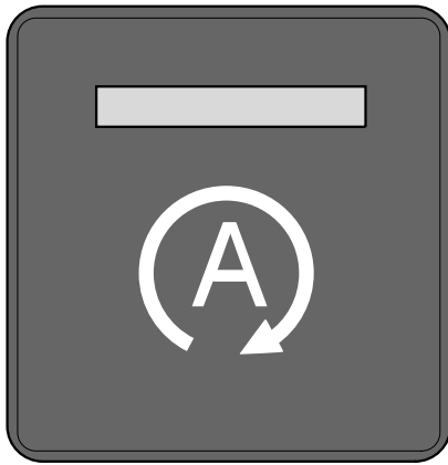
Gösterge panelinde rölantide durdurma ve çalıştırmayı devreden çıkaran kesme anahtarı.
