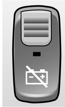
Gösterge panelindeki akü ana anahtarı düğmesi
