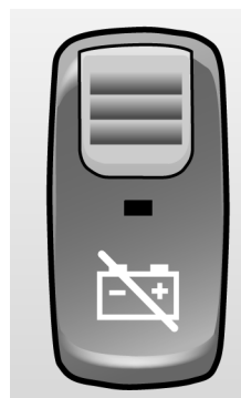
Interruttore per l'interruttore generale della batteria sul cruscotto
