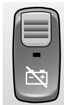
Schalter für Batterie-Hauptschalter in der Instrumententafel
