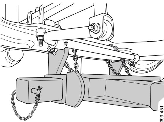
그림과 같이 차량의 앞부분도 빔 아래에서 들어올릴 수 있습니다. 프론트 액슬의 최대 하중은 9톤입니다. 표시된 영역 내에서 그림은 구난 차량의 드로우 빔에 적용할 수 있는 여러 클램핑 위치(A, B, C)를 보여줍니다. 클램프는 스카니아에서 제공하지 않습니다. 워터 파이프 등이 손상되지 않도록 각별히 주의해야 합니다.
