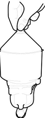
**Wenn die Mutter mit einem Werkzeug festgezogen wird, können Rotorwelle, Mutter oder Rotorbehälter beschädigt werden.**
